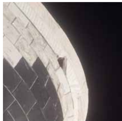
今回、見つかった耐熱ブランケット剥離箇所のクローズアップ
