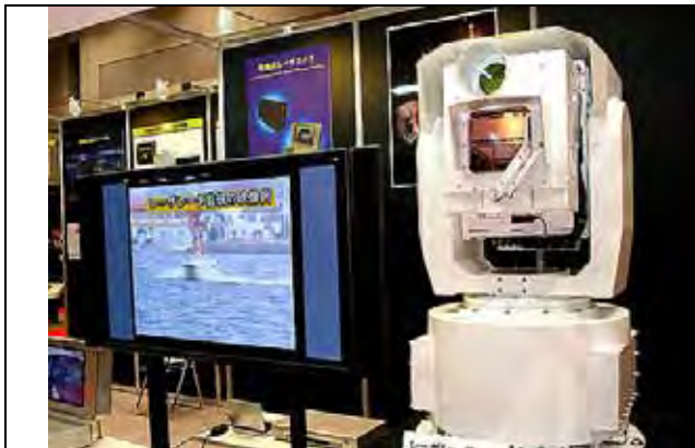
相手に探知されることなく長距離監視ができる全天候型の「レーザ・レーダ監視システム」(三菱重工)
